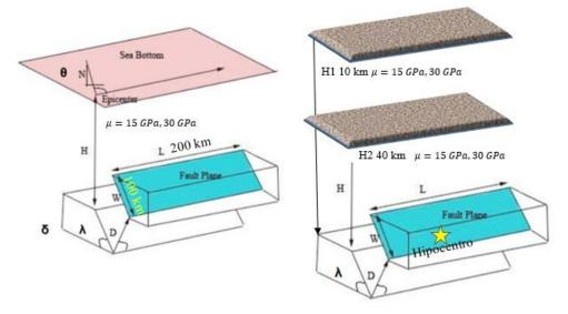
Figura 3. Parámetros de ruptura de fallas (Imamura & Yalciner, 2006).
