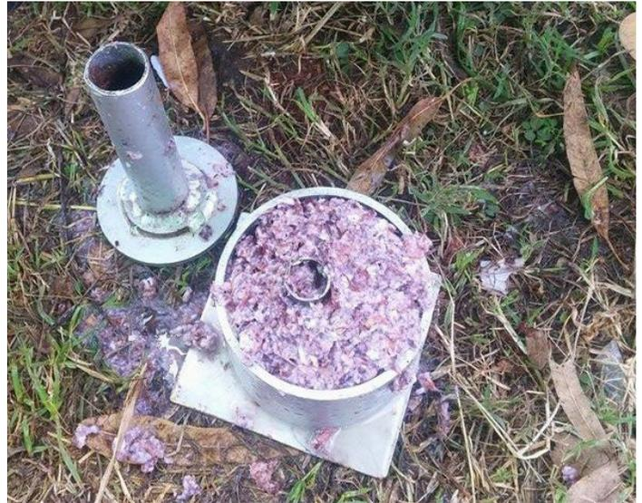
**5. Verter la mezcla en el molde:** se vacía la mezcla homogénea en el recipiente movable del prototipo de maquina briketadora el cual le dará la forma circular con un orificio al centro lo cual permite la entrada de oxígeno a la briketa para su combustión.
