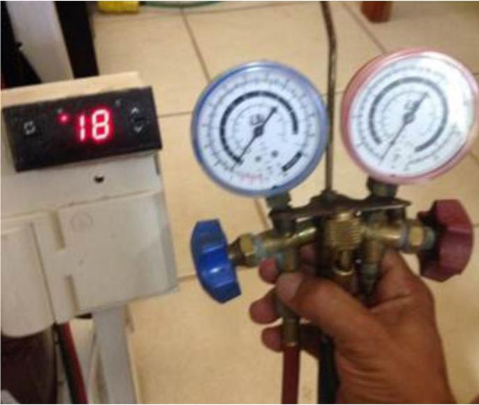
**Imagen 3. Manómetro para medir la presión**
