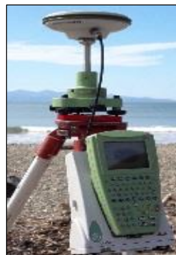
Figura 8. GPS doble frecuencia y estación Total
