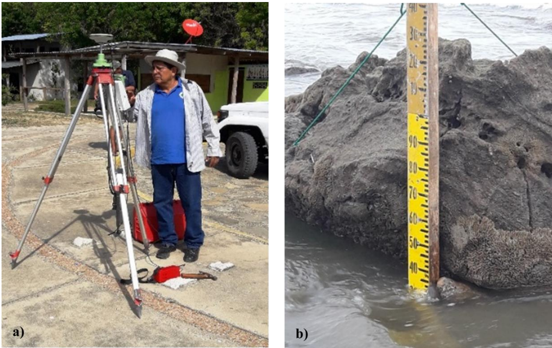
Figura 2. a) GPS de Precisión b) puesto de observación de mareas.
