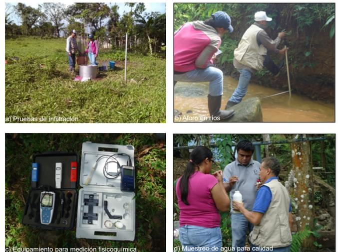
Figura 2. a) Prueba de infiltración, b) Aforo en el río Artiguas, c) Equipo utilizado para medición fisicoquímica y d) Toma de muestra de agua para calidad.
