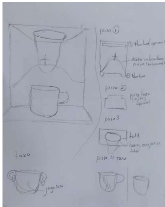
Ilustración 79 Dibujo técnico del "Chorreador de café"
